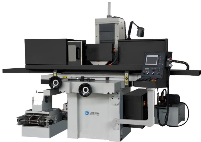
平面磨床在使用过程中会在工件表面产生线条，很多客户认为是自己操作的问题，那么这是什么情况，如何预防这个问题呢？磨削振纹的原因有两种，一种是工件的强制振动，另一种是加工参数不合理，导致工件的自激振动。可以理解，第1种振动存在于环境中，即使没有磨削，平面磨床也会启动。碰巧一些振动频率接近工件的共振频率，导致磨削振动线。产生这些振动的可疑部件包括安装在旋转部件中的轴承、驱动带和液压部件。第二类是加工过程中的周期性变化，其频率与工件的共振频率一致，导致振动线。这种振动可以通过调整加工参数来减少。或者选择硬度较低、粒度较厚的砂轮。因为如果平面磨床的刚度比价差，用锋利的砂轮降低磨削力也可以在一定程度上减少振纹。精密平面磨床主要是用砂轮旋转研磨工件以使其可达到要求的平整度。广东矩形台平面磨床售价单
