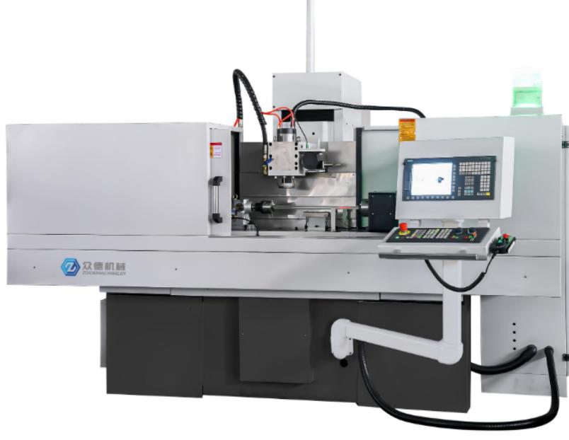
数控平面磨床的加工有些什么常识？1、零件的加工批量应大于普通磨床批量：数控平面磨床在非数控平面磨床加工中、小批量零件时，由于各种原因，纯切削时间只占实际工时的10%—30%。在磨削加工中心这一类多工序集中的数控平面磨床上加工时，这个比例有可能上升到70%—80%，但准备调整工时又往往要长的多，所以零件批量太小时就会变得不经济。2、加工的零件应符合能充分发挥数控平面磨床多工序集中加工的工艺特点：数控平面磨床加工零件时砂轮切削工件的情况与对应的非数控平面磨床是完全一样的，但它可进行一些有加工精度要求的复合加工，如在磨削范围方面，普通磨床主要用于磨削圆柱面、锥面或阶梯轴肩的端面普通磨床磨削，数控外圆磨床除此外，还可磨削圆环面（包括凸及凹只面），以及以上各种形式的复杂的组合表面。
